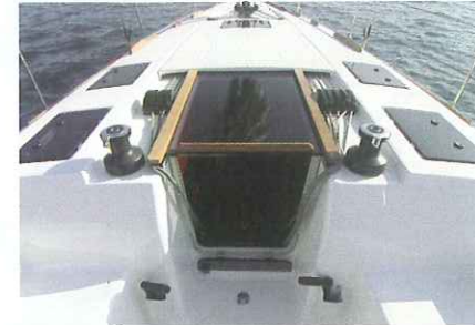
La zona del tambuccio consente una corretta posizione per il drizzista senza perdere di vista la comodità dettata dai 4 osteriggi, di cui due per cabina di poppa e bagno. In opzione si può montare uno sprayhood
