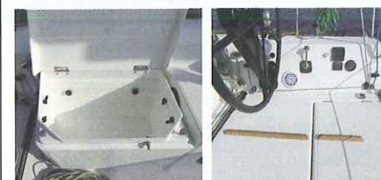
I piccoli gavoncini sotto le panche sono in realtà dei cassoni smontabili con facilità per le regate
