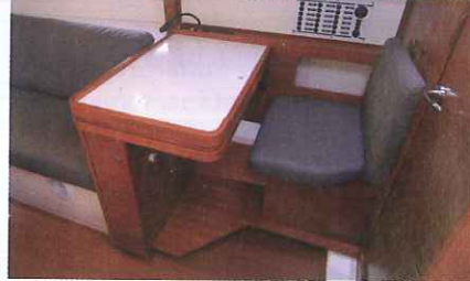
Buone le dimensioni del piano di carteggio, furbo il pannello per il plotter che si inclina per migliorarne l'uso
