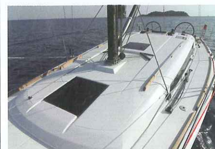
Gli osteriggi a filo e le manovre recesse, oltre che raffinare l'estetica, consentono di stendere sulla tuga cuscini prendisole. La falchetta di legno, interna ai candelieri, limita un po' la larghezza dei passavanti
