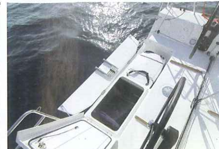
A poppa si apre un portello di accesso al grande gavone che arriva fino alla paratia del bagno, mentre sulla sinistra si trova un vano dedicato all'autogonfiabile il cui portello, però, non è dotato di cerniere
