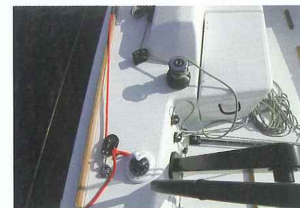
La zona intorno alle timonerie presenta qualche problema di spazio: stando in piedi si urta sul paterazzo, mentre seduti si è disturbati dalle bussole, che sarebbe meglio spostare sul bordo finale dei paraonde
