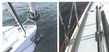
Lo spazio del timoniere è penalizzato dalla posizione del trasto sdoppiato e dai puntapedi poco efficaci
