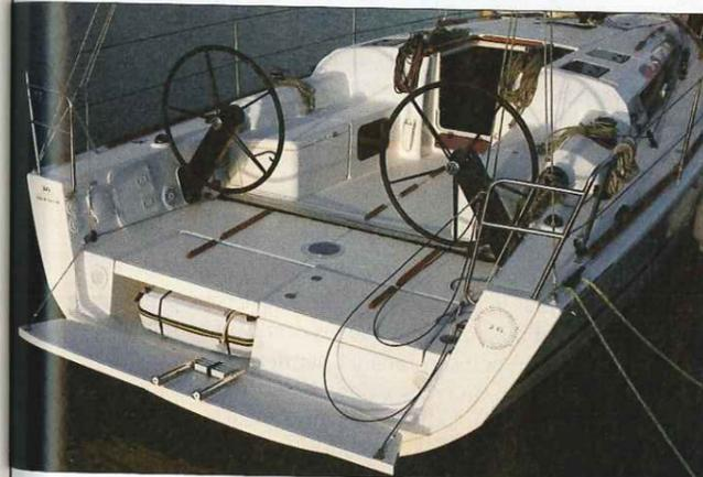
« Le grand cockpit ouvert est idéal en régate comme en croisière où l'on accède facilement à la mer grâce aux deux barres à roue et au tableau arrière basculant.
