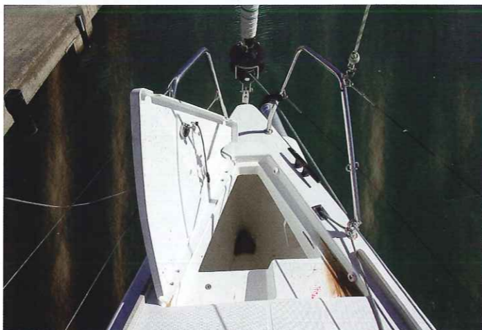
El cofre de fondeo es muy profundo y dispone de soporte para un molinete interior.
