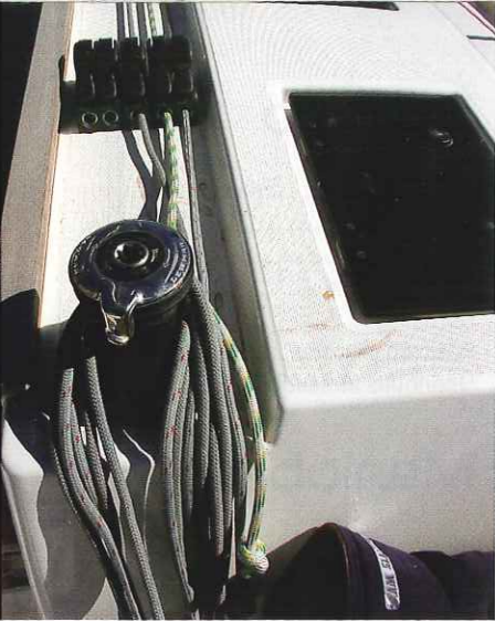
Los winches superiores se alinean con los stoppers del reenvío de las drizas.
