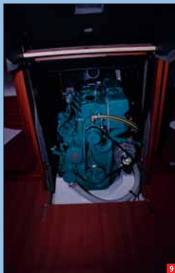
▲ El motor queda bien insonorizado bajo la escalera de acceso al salón.
