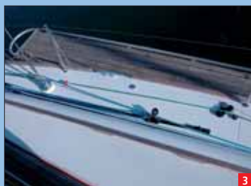
Los largos escoteros de génova están colocados entre el exterior del roof y el cadenote de los obenques.
