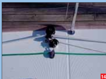
▲ El barber y las escotas de spi cuentan con su arraigo acertadamente ubicado en el exterior de la cubierta.
