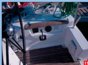
▲ Para el gobierno del motor se han ubicado los relojes y la palanca de cambio a estribor de la bañera del patrón.
