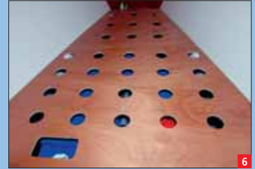
▲ La tapa del colchón de proa está debidamente agujereado para aireación.
