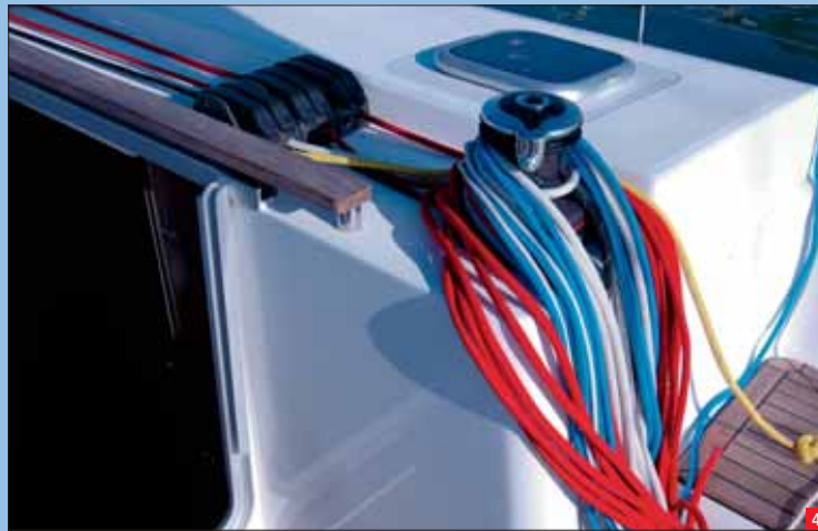
El piano cuenta con todos los reenvíos desde el pie de mástil, con los stoppers y winches a cada banda.
