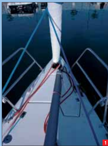
▲ El enrollador de génova queda instalado a ras de cubierta.
