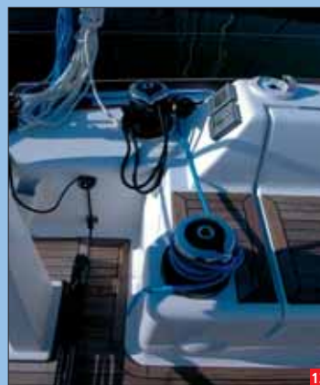
El piano cuenta con todos los reenvíos desde el pie de mástil, con los stoppers y winches a cada banda.
