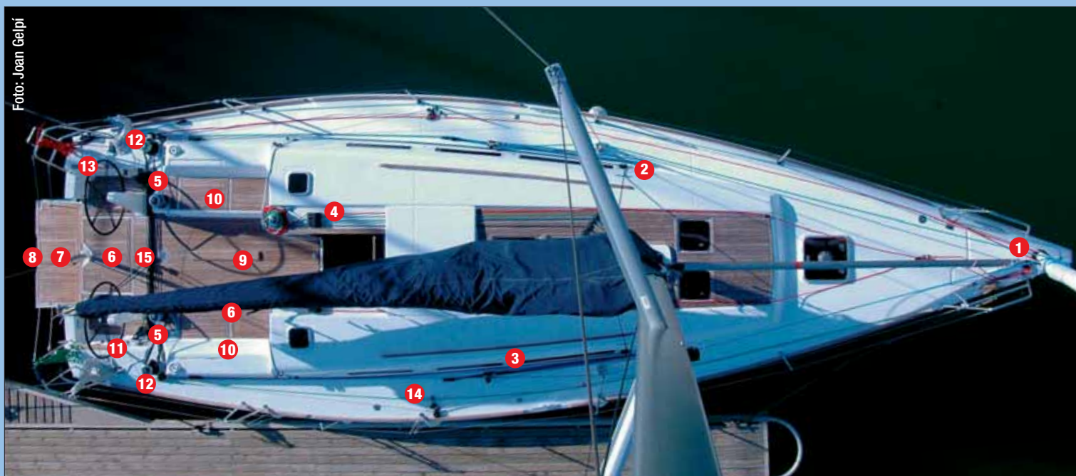
1. Enrollador de génova enrasado en cubierta; 2. Cadenotes obenques; 3. Escoteros de génova; 4. Piano; 5. Winches de génova; 6. Estiba bajo cubierta de popa; 7. Anclaje backstay; 8. Espejo de popa /plataforma de baño abatible; 9. Calapiés extraíble en bañera; 10. Cofres de estiba de bañera; 11. Relojes y palanca motor; 12. Winches mayor; 13. Cofre del gas; 14. Barber y escotas spi; 15. Barra escota mayor
