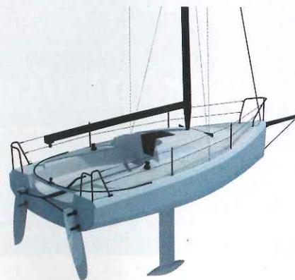
Longueur: 6,50 m. Largeur: 3 m. Tirant d'eau: 2 m. Déplacement: 1 000 kg. Surface de voile: 42 m<sup>2</sup>. Matériau: sand. epoxy. Architecte: G Yacht Design. Constructeur: AWS. Prix: 56 400 €.
